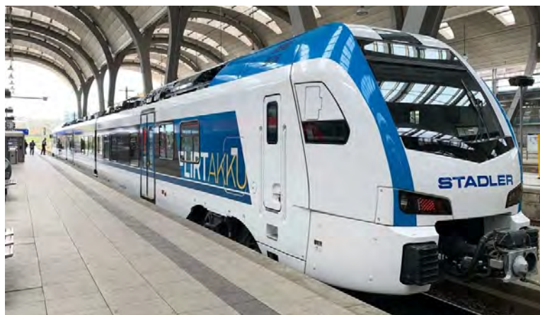
Elektra traktio nutrita alternative el kontaktlineo aŭ akumulatoro (© Stadler Rail AG)
